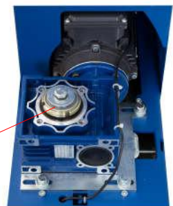
Motore brushless ("senza spazzola") con limitatore di coppia. Per proteggere il riduttore dai danni causati dai movimenti forzati dei pallet sulla tavola girevole.
