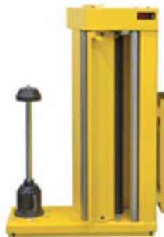
CF4, carrello con freno a rullo magnetico. Pre-stiro controllato da OP fino al 200%
